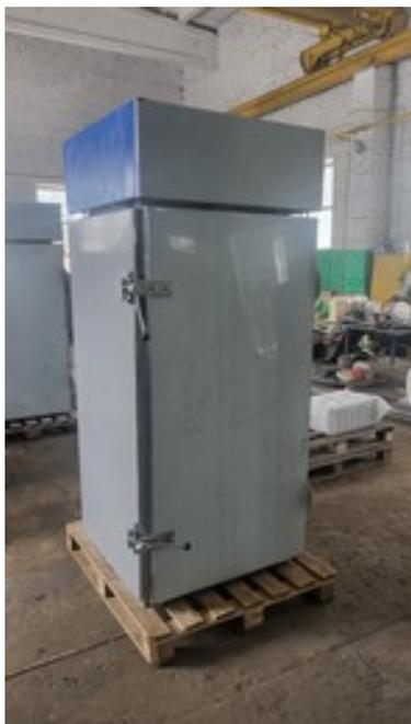
Камера термодымовая ЗС-24/КТ200 200 кг (внутри нержавейка, однорамная, с рамой)
