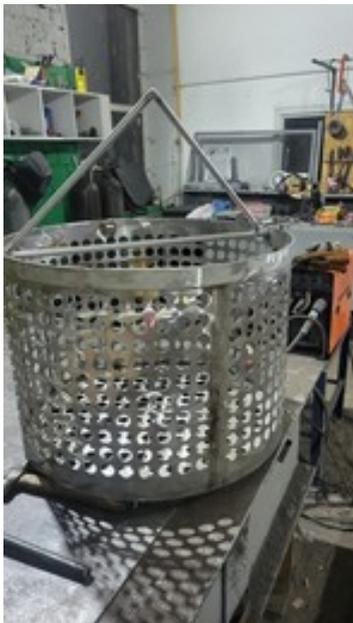
Корзина предназначена для загрузки банок с продуктом в автоклавы серии ЗС-24/03 для последующей стерилизации при производстве консервов. Выполнена из пищевой нержавеющей стали. Комплектуется четырьмя перфорированными полками из нержавеющей стали для банок.
