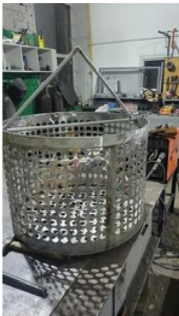
Корзина предназначена для загрузки банок с продуктом в автоклавы серии ЗС-24/01 для последующей стерилизации при производстве консервов. Выполнена из пищевой нержавеющей стали. Комплектуется четырьмя перфорированными полками из нержавеющей стали для банок.
