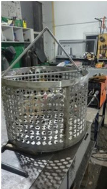
Корзина предназначена для загрузки банок с продуктом в автоклавы серии ЗС-24/02 для последующей стерилизации при производстве консервов. Выполнена из пищевой нержавеющей стали. Комплектуется четырьмя перфорированными полками из нержавеющей стали для банок.
